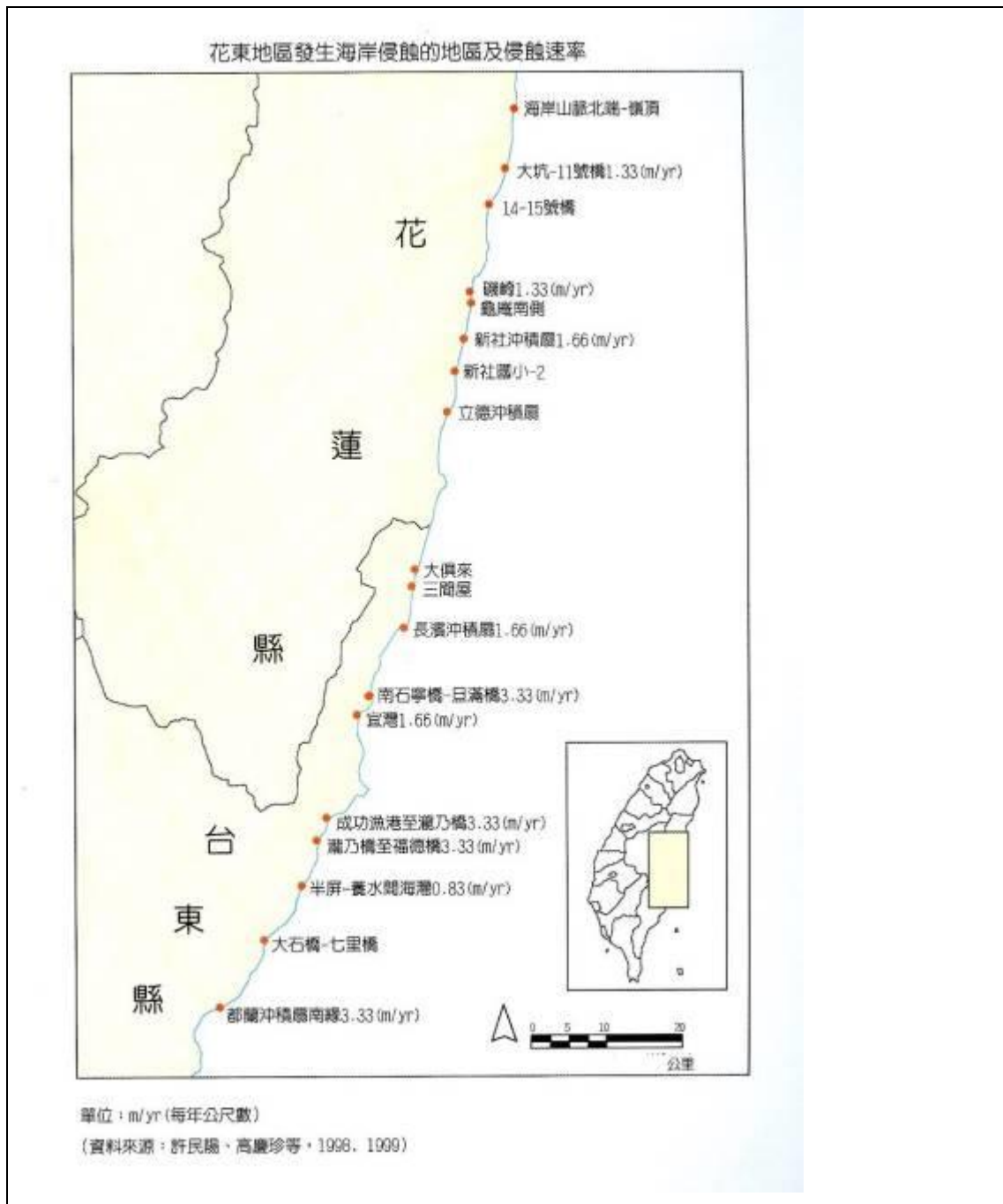
圖 1-42 花東海岸侵蝕地區與侵蝕率
